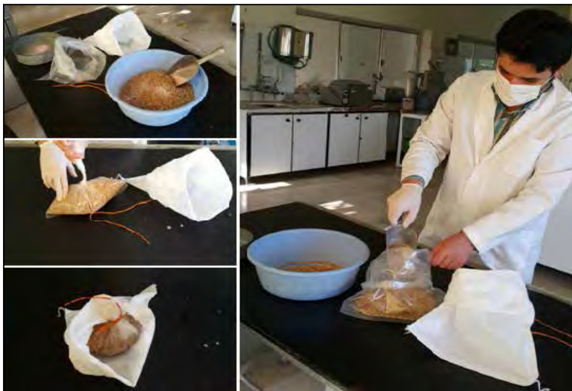
شکل ۱- هالوژناسیون، بسته‌بندی، فشردن محتویات و خروج هوای داخل بسته تا حد امکان
