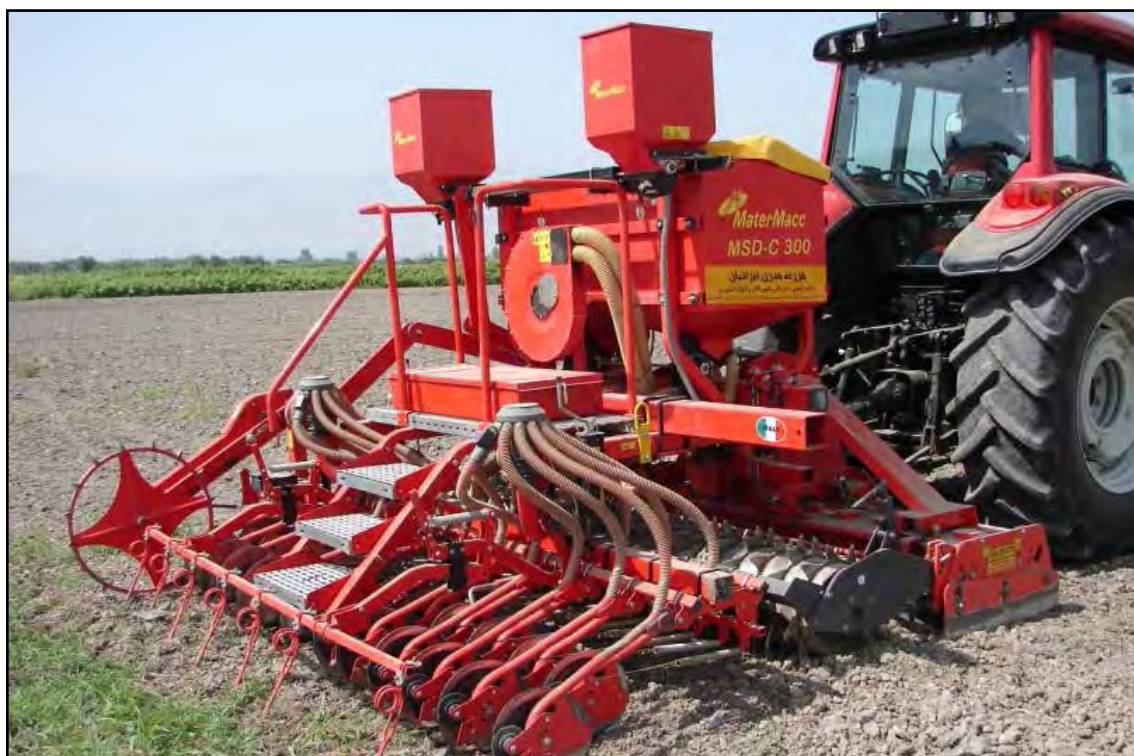
خطی کار چند کاره (کمپینات) برای کشت پنبه در ردیف های باریک
