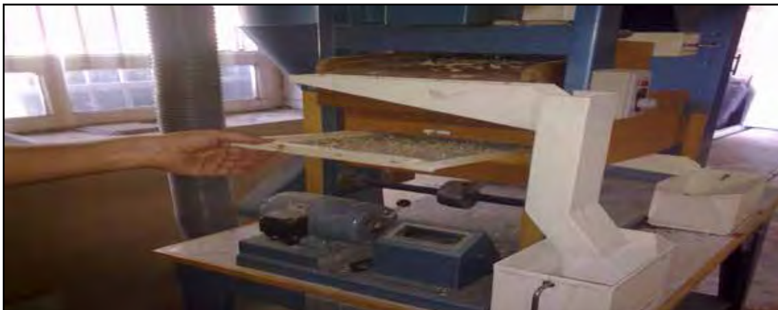
شکل - دستگاه بوجاری بذر با هوا موجود در کارگاه فرآوری بذر مؤسسه مدل Laboratory air/screen cleaner, LA-LS ساخت شرکت Westrup
