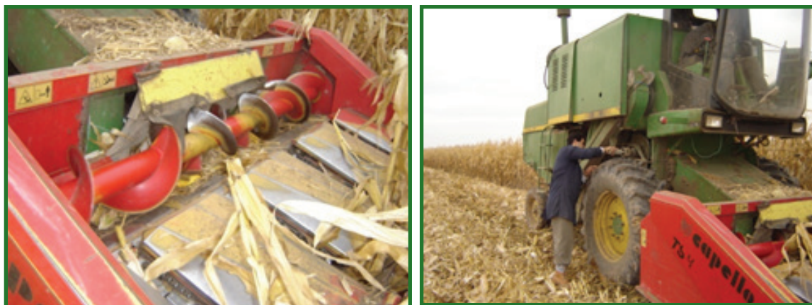
اندازه گیری سرعت کوبنده توسط تاکومتر (سمت راست) - اندازه گیری تلفات بلال در دماغه (سمت چپ)
