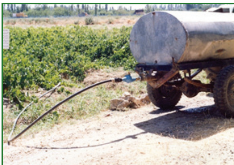
آبیاری و اندازه گیری در آزمایش به وسیله تانکر و کنتور
