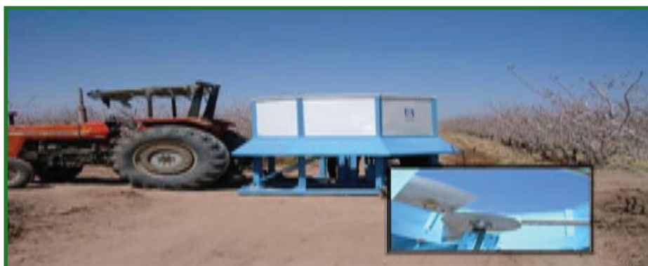
شکل ۱- چاهک معکوس با استفاده از نیروی P.T.O تراکتور
