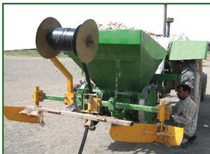
دستگاه غده کار دو ردیفه سیب زمینی به همراه نصب نوار آبیاری قطره ای
