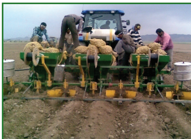
نمای مزرعه در زمان کاشت ۶ ردیفه غده های سیب زمینی و نصب همزمان نوارهای آبیاری قطره ای
