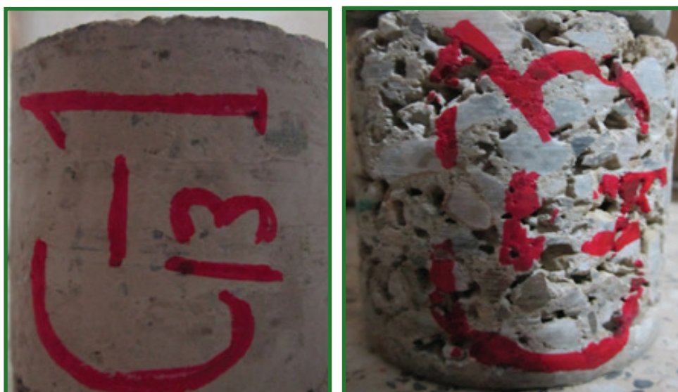
پوشش بتنی با معیارهای موجود (سمت راست) و نمونه بتن بادوام تهیه شده با نتایج یافته پژوهش (سمت چپ)
