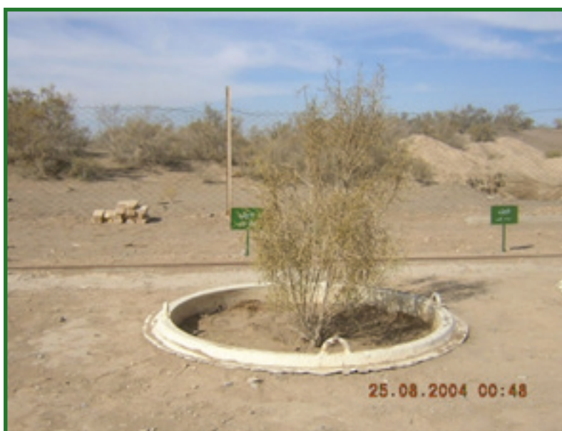
تعیین نیاز آبی تاغ از طریق آزمایش های لایسمتری
