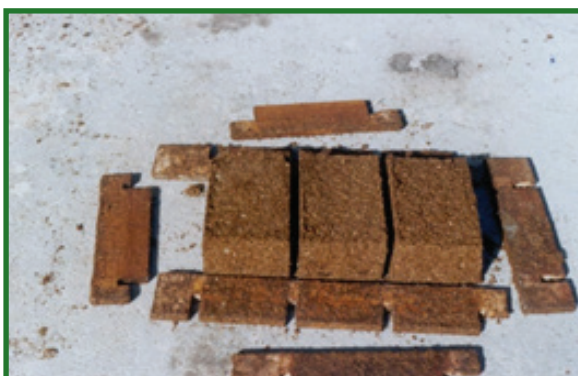
جدا کردن قالب چوبی و هوا خشک کردن بلوک
