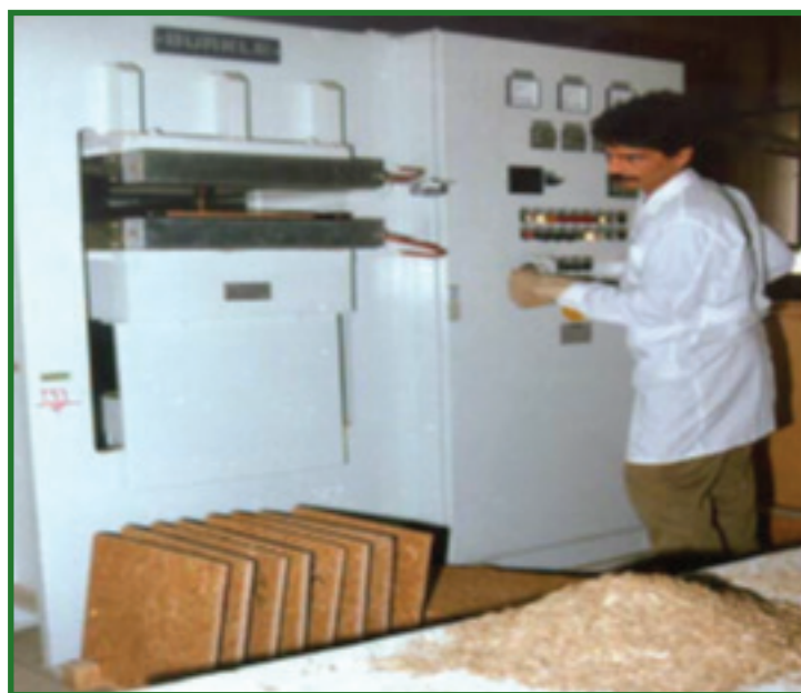
دستگاه پرس هیدرولیک جهت پرس کردن تخته خرده چوب آزمایشگاهی
