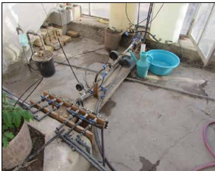
شکل ۱- سامانه اکسیژن - آبیاری در حال کار در گلخانه
