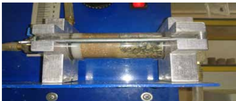
چگونگی فرسایش داخلی یک خاک واگرا در دستگاه آزمایش تعیین پتانسیل واگرایی
