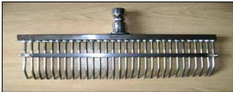
شکل شانه برداشت مورد نظر (مجهز به تیغه برش)
